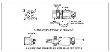
Fig. 3. Microphone plug wiring
